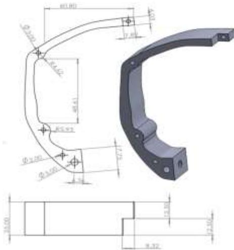
**Figura 3.** Cubierta inferior del robot de batalla 11b
